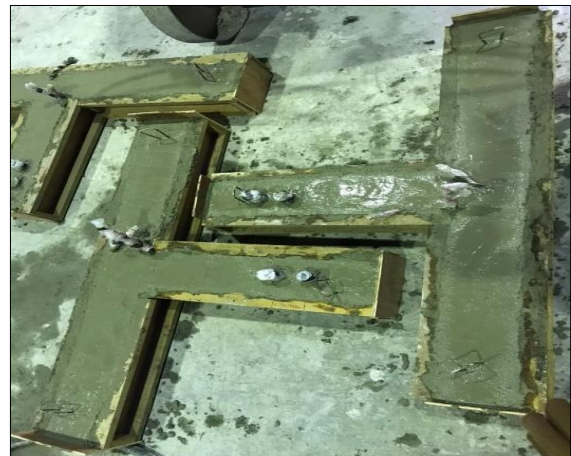
(d) Casting and Curing process of R-ECC
